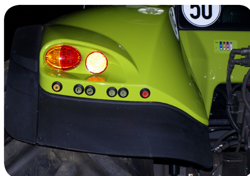
M30 Tasten am Heck eines Traktors zur Steuerung von z.B. einem Heckhubwerk
