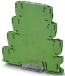
Das PLC-2R...24DC/1 ist ein Relais-Modul mit zwei integrierten, unabhängig voneinander ansteuerbaren Relais. Es wird eine enorme Kanaldichte von nur 3,1 mm Breite pro Schaltkanal erreicht. Der maximale Schaltstrom je Relais beträgt 3,5 A.
