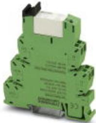
14 mm PLC-Relaiskomplettbaustein mit Push-in-Anschluss für Bahnanwendungen, Eingangsnennspannung 24 V DC, Bereich:  $0,7 \times U_N$  bis  $1,25 \times U_N$ , Temperaturklasse TX:  $-40 \text{ °C}$  bis  $+70 \text{ °C}$ . Entspricht EN 50155, EN 50178, EN 61373, EN 50121 und IEC 62103.
