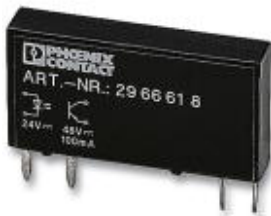
Steckbares Miniatur-Solid-State-Relais, Eingabe-Solid-State-Relais, Eingang: 24 V DC, Ausgang: 3 - 48 V DC/100 mA
