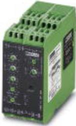
Überwachungsrelais zur Wirkleistungsüberwachung in 1- und 3-Phasennetzen von 0...7,2 kW, Unterlast, Überlast, Window, Motorwicklungstemperatur, Fehlerspeicher, Versorgungsspannung wählbar über Powermodul, 2 Wechsler
