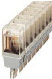
Relaisstecker, bestückt mit Siemens-KAMMRELAIS®, Kontakte (Ag): mittlere Leistungen, 1 Wechsler, Eingangsspannung 24 V DC, mit Leuchtanzeige, steckbar auf Grundklemmenblöcke
