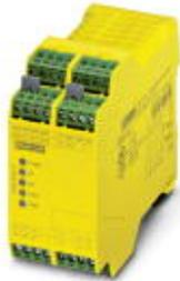
Sicherheitsrelais zur Not-Halt- und Schutztür-Überwachung bis SIL 3 oder Kat. 4, PL e nach EN ISO 13849, automatische oder manuelle Aktivierung, 3 Schließer, 1 Öffner, 2 Schließer abfallverzögert 1,0 Sek. Fest, steckbare Schraubanschluss-Klemmen
