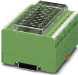
Lampenprüf-Modul, jeweils 2 Dioden mit gemeinsamer Kathode: Ausführung 8-paarig, zur einzelnen Beschaltung
