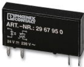
Steckbares Miniatur-Solid-State-Relais, Leistungs-Solid-State-Relais, Eingang: 24 V DC, Ausgang: 24-253 V AC/ 0,75 A
