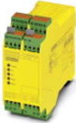
Sicherheitsrelais zur Not-Halt- und Schutztür-Überwachung bis SIL 3 oder Kat. 4, PL e nach EN ISO 13849, automatische oder manuelle Aktivierung, 3 Schließer, 1 Öffner, 2 Schließer abfallverzögert 0,5 Sek. Fest, steckbare Federkraftanschluss-Klemmen
