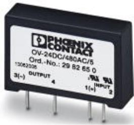
Solid-State-Relais, zur Signalverstärkung und galvanischen Trennung der Steuer- und Lastkreise, steckbar in einlötbaren Stecksockeln SIM-AMS bzw. mit Printanschluss zur direkten Montage auf der Leiterplatte, Eingang: 4-32 V DC, Ausgang: 12-530 V AC/5 A
