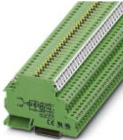
Relaisklemme, mit fest eingelöteten Miniaturrelais, Kontakt (AgNi+Au): kleine bis mittlere Leistungen, 1 Schließer, Eingangsspannung 24 V AC/DC, mit integrierten "Hand", "0", "Automatik" Umschalter, zur Montage auf NS 35/7,5, Klemmenbreite 6,2 mm
