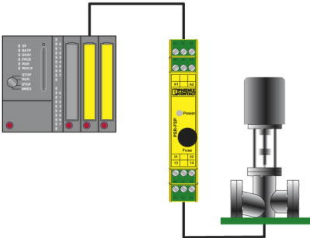
Beispiel einer galvanischen Trennung eines Sicherheits-SPS-Ausgangs vom Feld.
