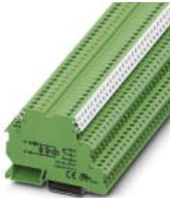
Relaisklemme, mit fest eingelöteten Miniatur-Leistungsrelais, Kontakte (AgSnO): mittlere bis große Leistungen, 1 Wechsler, Eingangsspannung 24 V DC, zur Montage auf NS 35/7,5, Klemmenbreite 6,2 mm
