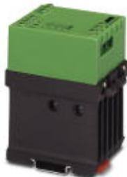
Elektronisches Wendelastrelais, zur direkten Ansteuerung von Verbrauchern im 3-Phasen-Netz, mit Leuchtanzeige und Schutzbeschaltung, Ausgang: 110-440 V AC/3 x 9 A
