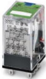
Steckbare Industrirelais mit Leistungskontakten und zusätzlicher Hartvergoldung, 4 Wechsler, Prüftaste, Status-LED, Freilaufdiode, mechanische Schaltstellungsanzeige, Polarität A1+, A2-, Spulenspannung: 220 V DC
