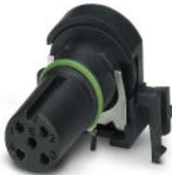
Sensor-/Aktor-Einbausteckverbinder, Buchse, 4-polig, A-kodiert, geschirmt, mit gewinkteltem Lötanschluss, nur Kontakteinsatz
