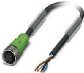
Sensor-/Aktor-Kabel, 4-polig, PUR halogenfrei, schwarzgrau RAL 7021, freies Leitungsende, auf Buchse gerade M12, A-kodiert, Kabellänge: 2 m
