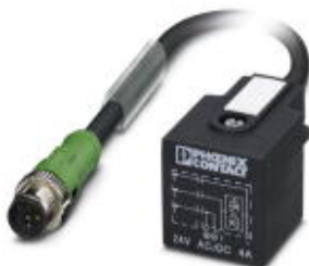
Sensor-/Aktor-Kabel, 3-polig, PUR halogenfrei, schwarzgrau RAL 7021, Stecker gerade M12, A-kodiert, auf Ventilstecker A, mit 1 LED, beschaltet mit Z-Diode, Kabellänge: 1 m
