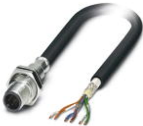
Bus-System-Einbaustecker, VARAN, 6-polig, M12, geschirmt, Hinterwand-/Schraubmontage mit M16-Gewinde, mit 0,5 m Buskabel
