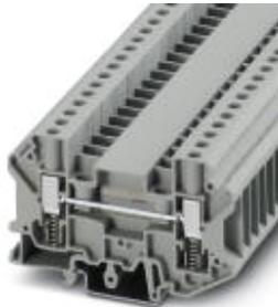
Durchgangsklemme, Anschlussart: Schraubanschluss mit Federunterstützung, Querschnitt: 0,2 mm<sup>2</sup> - 10 mm<sup>2</sup>, AWG: 24 - 8, Breite: 8,2 mm, Farbe: grau, Montageart: NS 35/7,5, NS 35/15, NS 32
