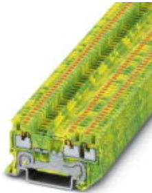
Schutzleiter-Reihenklemme, Anschlussart: Push-in-Anschluss, Querschnitt: 0,14 mm 2 - 1,5 mm 2 , AWG: 26 - 14, Breite: 3,5 mm, Höhe: 30,5 mm, Farbe: grün-gelb, Montageart: NS 35/7,5, NS 35/15
