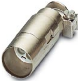
HEAVYCON EMV-Steckverbinder, Stiftvariante, 4-polig, zum Anschluss geschirmter Leiter von 3-9,5mm Leitungsaussendurchmesser. Zum Einsatz im Kunststoffmodul HC-M-EMV-MOD-ST
