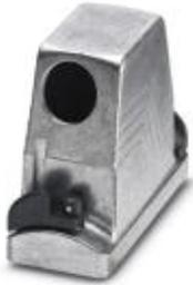
HEAVYCON ADVANCE Tüllengehäuse B16, mit Bajonettverriegelung (Innensechskant) aus Edelstahl, seewasserbeständiges Aluminium, Höhe 100 mm, mit Gewinde 1x M32, seitlichem Kabelabgang, ohne Oberfläche; leitfähige Dichtung (EMV-Eigenschaften)
