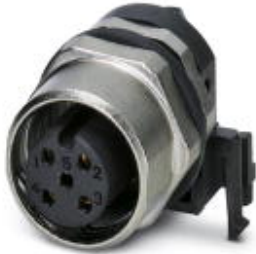
Sensor-/Aktor-Einbausteckverbinder, Buchse, 4-polig, M12-SPEEDCON, A-kodiert, Hinterwand-/Schraubmontage mit M12 Gewinde, verdrehgeschützt, mit gewinkeltm Lötanschluss
