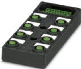
Sensor-/Aktor-Box-Grundgehäuse, Anschlussart: M12-SPEEDCON-Buchse Kunststoff, Anzahl der Steckplätze: 8, Polzahl: 5, Steckplatzbelegung: doppelt, Statusanzeige: Ja, pnp; Stammleitungsanschluss: Steckbarer Schraubanschluss, Schirmung: nein
