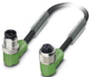
Sensor-/Aktor-Kabel, 4-polig, PUR halogenfrei, schwarzgrau RAL 7021, Stecker gewinkelt M12, A-kodiert, auf Buchse gewinkelt M12, A-kodiert, Kabellänge: 0,3 m
