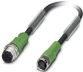
Sensor-/Aktor-Kabel, 3-polig, PUR halogenfrei, schwarzgrau RAL 7021, Stecker gerade M12, A-kodiert, auf Buchse gerade M8, Kabellänge: 1,5 m
