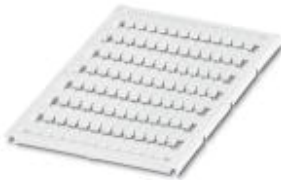
Marker für Klemmen, Matte, weiß, unbeschriftet, beschriftbar mit: BLUEMARK CLED, BLUEMARK LED, Plotter, Montageart: Verrasten in hoher Schildchennut, Schriftfeldgröße: 4,45 x 8,75 mm
