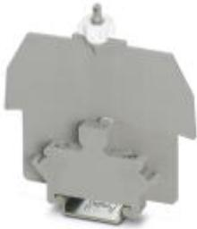
Plombierbarer Abdeckprofilträger, zur Montage auf NS NS 35/7,5-Tragschiene, zur Befestigung des Abdeckprofils AP 3, mit Kunststoff-Rändelmutter M5, Platzbedarf: 13 mm
