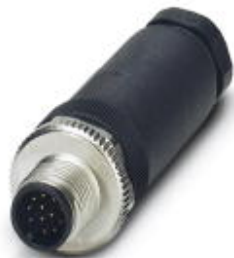
Steckverbinder, Universal, 12-polig, Stecker gerade M12, A-kodiert, Lötanschluss, Rändelmaterial: Zinkdruckguss, vernickelt, Kabelverschraubung Pg9, Kabelaußendurchmesser 6 mm ... 8 mm
