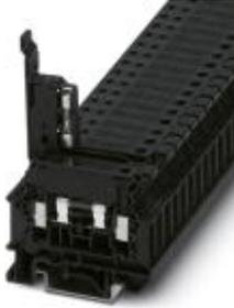
Sicherungsreihenklemme, Polzahl: 1, Anschlussart: Schraubanschluss, Querschnitt: 0,2 mm<sup>2</sup>- 6 mm<sup>2</sup>, AWG: 24 - 10, Nennstrom: 6,3 A, Nennspannung: 500 V, Breite: 8,2 mm, Sicherungstyp: G / 5 x 20, Art der Sicherung: Glas, Montageart: NS 35/7,5, NS 35/15, NS 32, Farbe: schwarz
