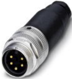
Sensor-/Aktor-Stecker, Stecker, gerade, 5-polig, 7/8", Schraubanschluss, Metallrändel, Kabelverschraubung Pg9
