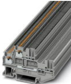
Doppelstock-Klemme, Querschnitt: 0,14 mm 2 - 1,5 mm 2 , AWG: 26 - 14, Anschlussart: Push-in- / Steckanschluss, Breite: 3,5 mm, Farbe: blau, Montageart: NS 35/7,5, NS 35/15
