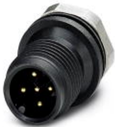
Sensor-/Aktor-Einbausteckverbinder, Stecker, 5-polig, M12, A-kodiert, Vorderwand-/Schraubmontage mit M12 Gewinde, mit Lötkelchen, Kunststoff-Ausführung
