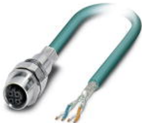
Bus-System-Einbaubuchse, ETHERNET, 4-polig, M12, geschirmt, D-kodiert, Vorderwand-/Schraubmontage mit M16-Gewinde, positionierbar, mit 1 m Buskabel, 2 x 2 x 0,14 mm 2
