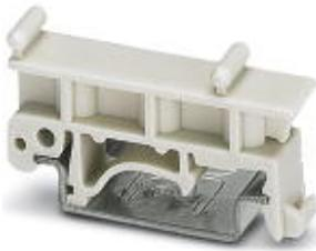
Fußelement, zur Montage auf Tragschiene NS 32, Tragschiene NS 35/7,5 oder Tragschiene NS 35/15, zwischen Basis- und Seitenelement steckbar
