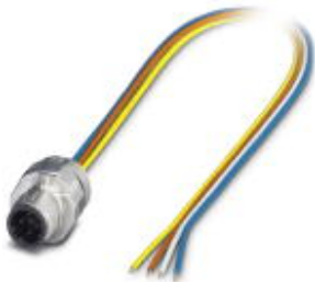
Bussystem-Einbausteckverbinder, 4-polig, Stecker gerade M12-SPEEDCON, D-kodiert, Vorderwandmontage, positionierbar, M16 x 1,5, Einzellitzen, Kabellänge: 0,5 m
