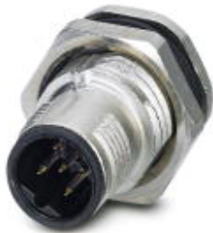
Sensor-/Aktor-Einbaustecker, 5-polig, M12-SPEEDCON, geschirmt, B-kodiert, Hinterwand-/Schraubmontage mit Pg9-Gewinde, mit geradem Lötanschluss
