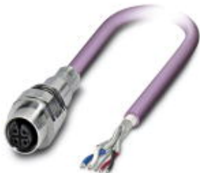
Bus-System-Einbaubuchse, DeviceNet/CANopen, 5-polig, M12, geschirmt, A-kodiert, Vorderwand-/Schraubmontage mit M16-Gewinde, positionierbar, mit 5 m Buskabel, 2 x 0,2 mm 2 ; 2 x 0,32 mm 2
