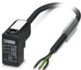
Sensor-/Aktor-Kabel, 3-polig, PUR halogenfrei, schwarzgrau RAL 7021, freies Leitungsende, auf Ventilstecker CI (9,4 mm), mit 1 LED, beschaltet mit Z-Diode, Kabellänge: 1,5 m
