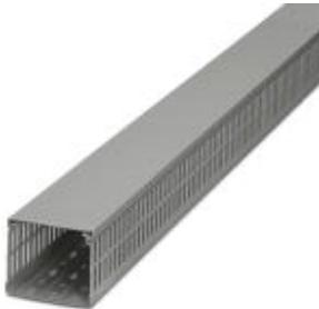
Verdrahtungskanal, grau, bestehend aus Ober- und Unterteil, Breite: 100 mm, Höhe: 80 mm, Länge 2000 mm
