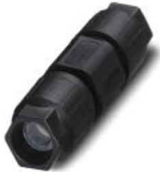
QUICKON-Leitungsverbinder, schwarz, 3+PE-polig, 0,75 mm 2 ... 1,5 mm 2 / 500 V / 15 A, für Kabeldurchmesser 6 mm ... 12 mm.
