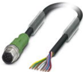
Sensor-/Aktor-Kabel, 8-polig, PUR halogenfrei, schwarzgrau RAL 7021, Stecker gerade M12, A-kodiert, auf freies Leitungsende, Kabellänge: 1,5 m
