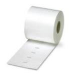
Einsteckschild, Rolle, weiß, unbeschriftet, beschriftbar mit: THERMOMARK ROLL, THERMOMARK X, THERMOMARK S1.1, Montageart: Einschieben, Kabeldurchmesser: 0,6-50 mm, Schriftfeldgröße: 15 x 4 mm
