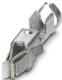
Modul-Buchsenkontakt, wird nach dem Ankrimpen des Leiters in das PCC oder HCC Steckergehäuse geschoben, für Leiter von 1,0 mm<sup>2</sup> ... 2,5 mm<sup>2</sup>, Bandkontakt
