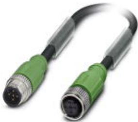
Sensor-/Aktor-Kabel, 5-polig, PUR halogenfrei, schwarzgrau RAL 7021, geschirmt, Stecker gerade M12, A-kodiert, auf Buchse gerade M12, A-kodiert, Kabellänge: 1,5 m
