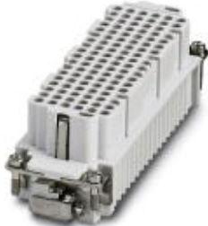
HEAVYCON Buchseneinsatz, Serie DD108, 108-polig, 109 ... 216 bedruckt, Crimpanschluss. PE-Anschluss mittels Zughülstechnik.
