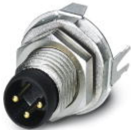
Sensor-/Aktor-Einbausteckverbinder, Stecker, 3-polig, M8, Hinterwand-/Schraubmontage mit M8-Befestigungsgewinde, mit geradem Lötanschluss
