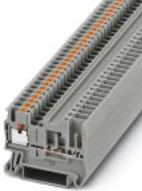
Durchgangsklemme, Anschlussart: Push-in- / Steckanschluss, Querschnitt: 0,14 mm 2 - 4 mm 2 , AWG: 26 - 12, Breite: 5,2 mm, Höhe: 35,3 mm, Farbe: grau, Montageart: NS 35/7,5, NS 35/15
